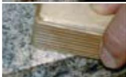
Überschüssiges Material mit **AKELUX** Hobel abnehmen. Für Kalkstein empfehlen wir den Gebrauch von Sepia-Schalen.
