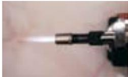
Bei Kalkstein (z.B. Marmor) mit **AKELUX** Pyrosil Brenner die Oberfläche ca. 5 sec mit dem „blassblauen“ Flammenbereich beflammen.\*
